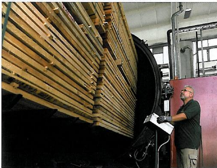
Gestapeltes Schnittholz wird in einen der insgesamt vier Druckbehälter geschoben. Jeder dieser insgesamt vier 40 t wiegenden Stahlkessel ist 15 m lang und 3,60 m breit. Anschließend wird eine bis auf 100 °C erhitzte Wachsmischung hinzu gepumpt, mit der das Holz komplett durchtränkt wird. Erst dann ist es „Dauerholz“.
